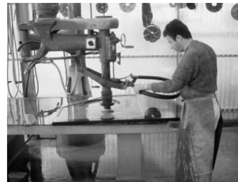
Foto 3 Küchenabdeckung bei der Endbearbeitung. Durch den andauernden Wasserkontakt ist das Gestein am Ende vollständig mit Wasser gesättigt und benötigt darum eine angemessene Trocknungszeit, bevor die Imprägnierung aufgebracht werden kann.
